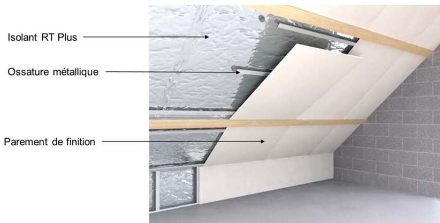
Schéma 4 : Mise en œuvre de l'ossature métallique et du parement de finition
